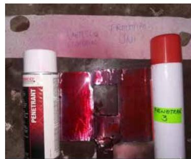
Comentario: Se observa revelado más parejo en el Developer de Cantesco respecto a la muestra 4 de Revelador, se aprecia un soplado debido a que se esparció muy cerca de la superficie
